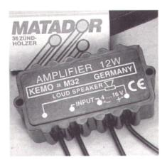
Außerdem sollte man dafür sorgen, daß das Kabel für die NF-Zuleitung abgeschirmt ist; der Schirm wird mit Masse verbunden (Minuspol). Wenn man direkt ein Mikrofon anschließen will, ist ein separater Vorverstärker erforderlich (z.B. aus **E-A-M** 7/91).
